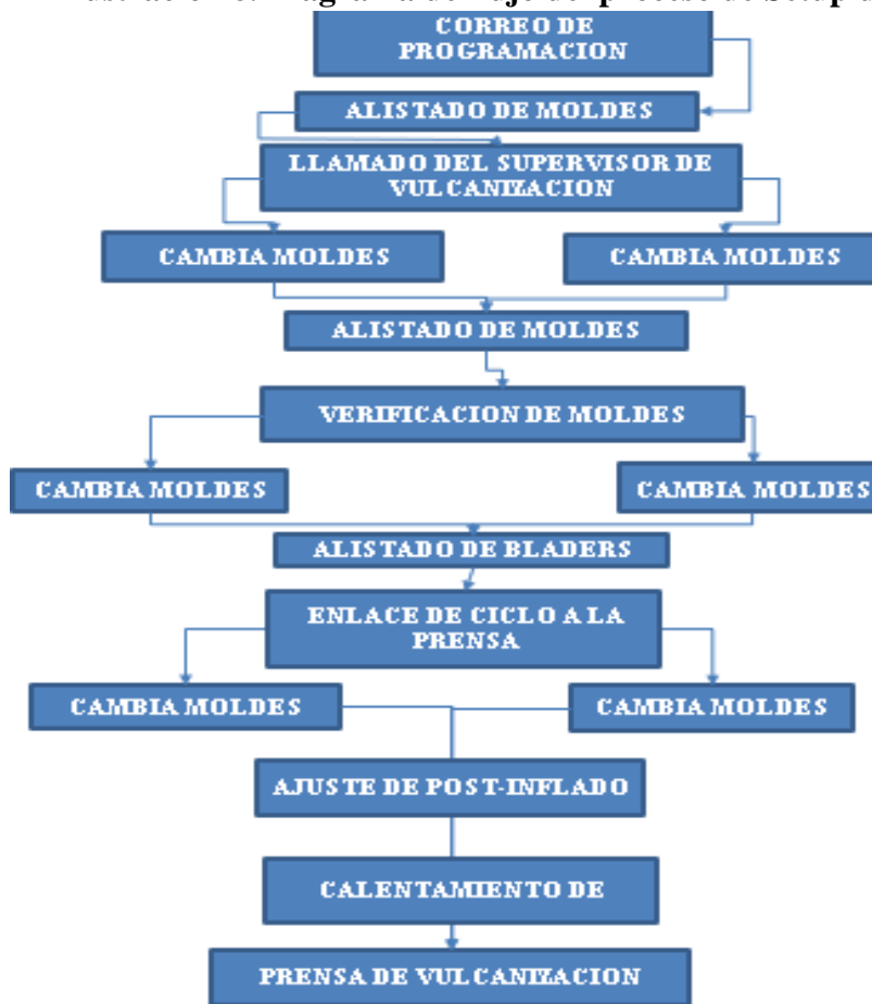
Ilustración 8. Diagrama de flujo del proceso de Setup de Molde
