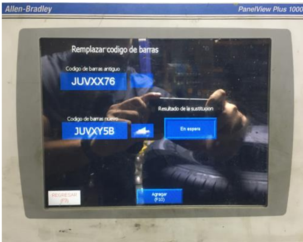
Figura 19 Sistema de transferencia de información de código de barras, panelview.
