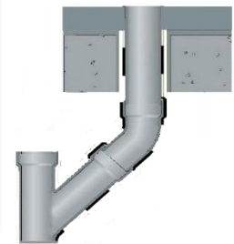
Detalle de bajante de losa de cubierta
