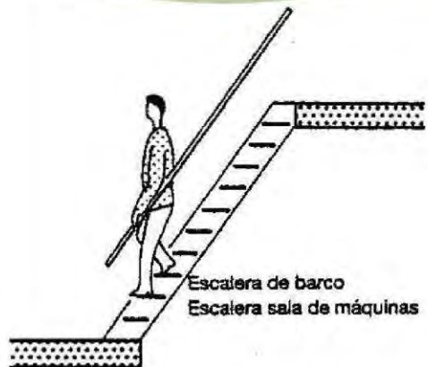
4 Escaleras a la molinera con barandilla
