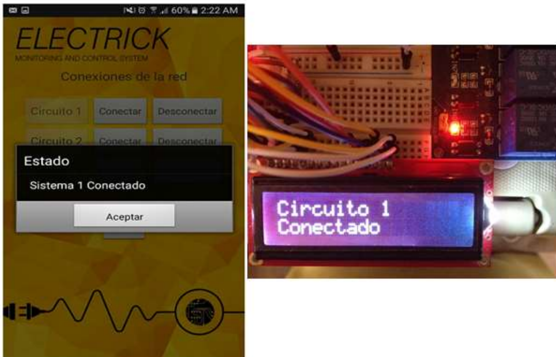
Figura 62. Conexión 1 Activada desde la Aplicación o Panel de Control, y Respuesta del Sistema.
