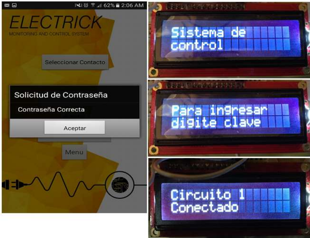
Figura 65. Seguridad de Acceso a Sistema de Control.
