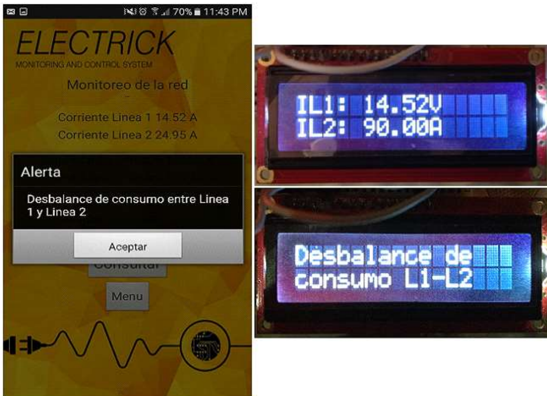
Figura 59. Alerta del Sistema por Desbalance de Consumo entre las Líneas de la Red, desde la Aplicación Móvil y Panel del Prototipo
