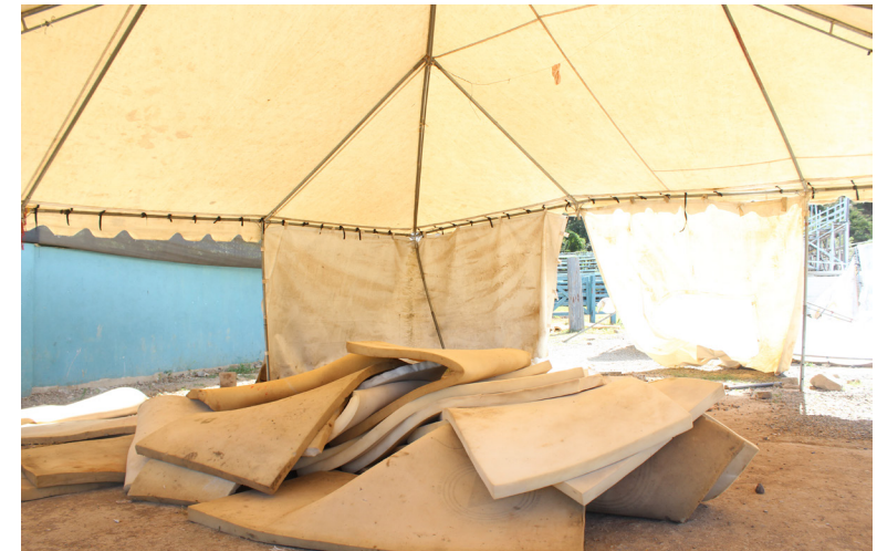
i-1.18. - Espumas mal almacenadas y deterioradas. 28 de enero, 2017
