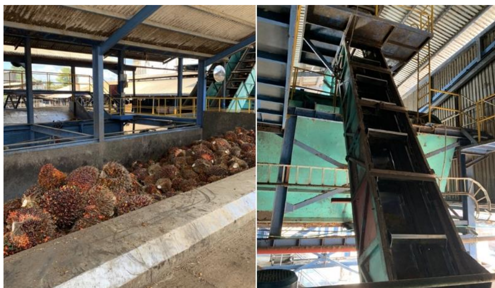
Figura 14. Rampa de recepción de los racimos de fruta de palma, Latin America Agrialim S.A.
