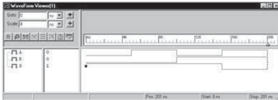
Figura 4.62. Resultado de la simulación, a partir de una descripción en VHDL, de una puerta NAND
