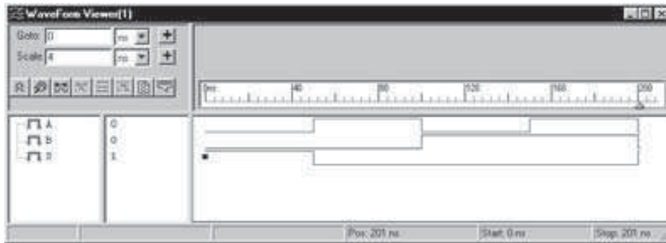
Figura 4.76. Resultado de la simulación, a partir de una descripción en VHDL, de una puerta NOR.
