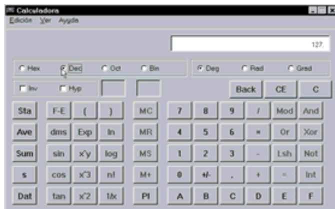
Figura 1.17. Valor decimal del mayor número positivo que se puede almacenar en un byte, incluido el signo, mediante el convenio del complemento a dos
