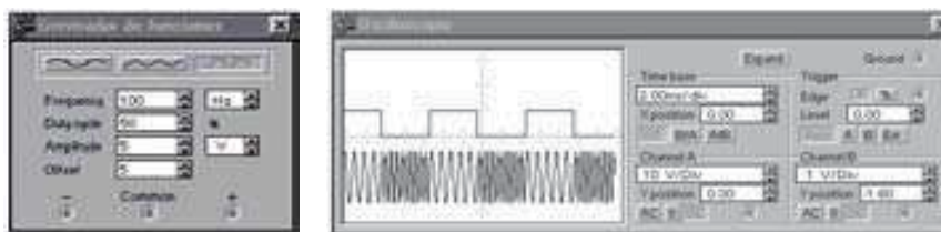
Figura A.9. Detalle de una señal con modulación FSK
