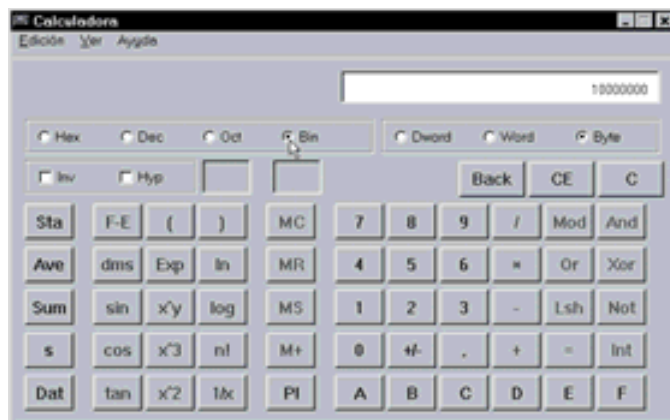
Figura 1.18. Representación binaria del mayor número negativo que se puede almacenar en un byte, incluido el signo, mediante el convenio del complemento a dos
