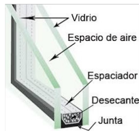
Ventanas fijas con doble vidrio laminado
