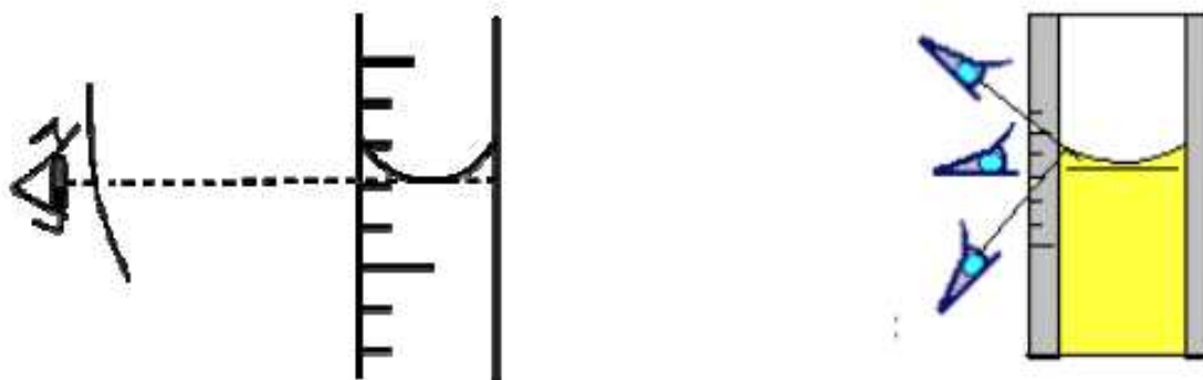
Figura 2: Muestra la forma correcta y la incorrecta de leer el menisco para tomar la medición de volumen en una probeta, bureta o pipeta graduada.
