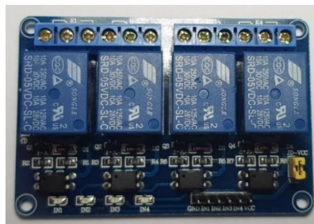
Figura 4. Módulo de relés de cuatro canales
