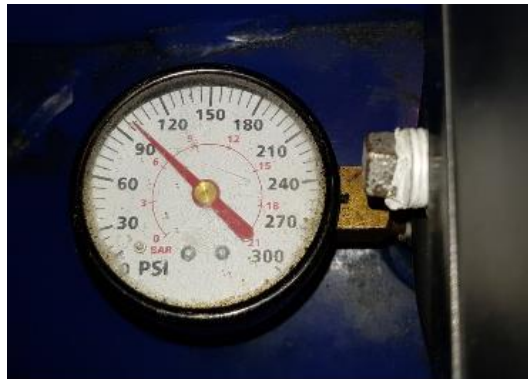
Figura 18. Manómetro analógico actual
