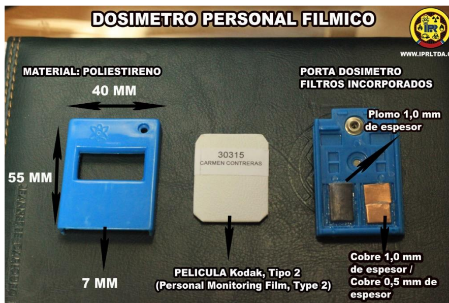
Figura 2. Dosímetro personal filmico. Instituto de Protección Radiológica (2019)
