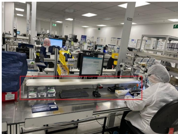
Figura No. 9 Estación de trabajo 5-Unión de cables y ensamblaje de cobertores, Ensamble Final
