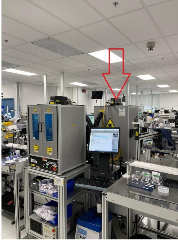
Figura No. 14 Máquinas Láser utilizadas en proceso de Unión de cables y ensamblaje de cobertores
