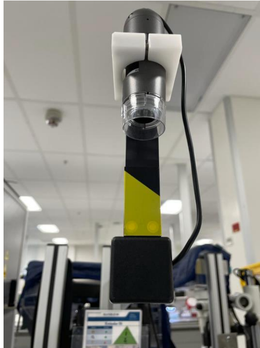
Figura No. 12 Cámara utilizada en proceso de Unión de cables y ensamblaje de cobertores
