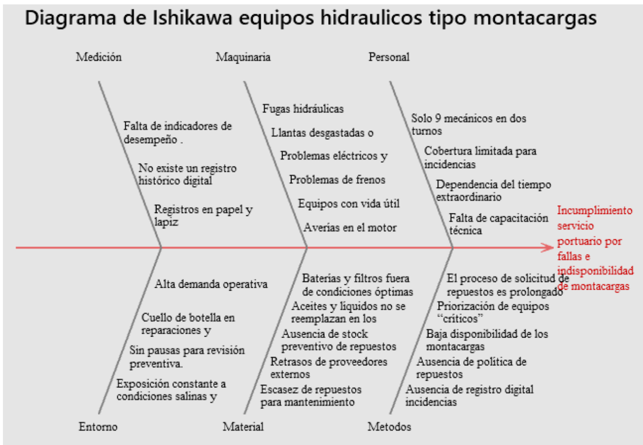
Figura 29. Diagrama de Ishikawa de los equipos hidráulicos tipo montacargas del 01 de diciembre 2024 al 31 de mayo 2025
