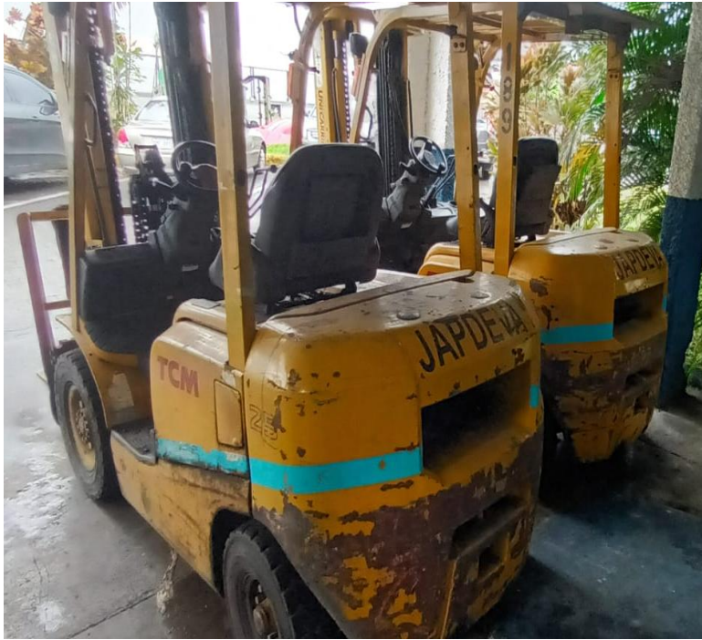
ANEXO 24 Imagen N°4 Equipo hidráulico tipo montacarga privado de 2.5 toneladas en operación.
