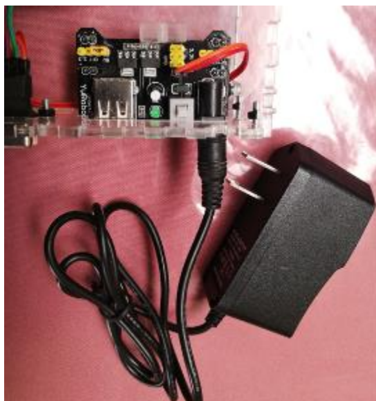
Figura 63 Fuente de alimentación del sistema de control Fuente: Elaboración propia.
