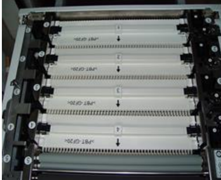
Figura 6 Tanques internos de químicos de reveladora de placas AGFA Fuente: Elaboración propia
