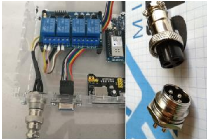
Figura 43 Conexión de relés a bombas de regeneración Fuente: Elaboración propia
