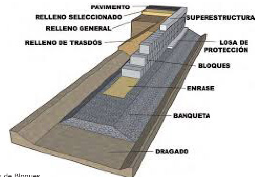
Figura 115 Muelles de Bloques Fuente: http://www.abcpuertos.cl
