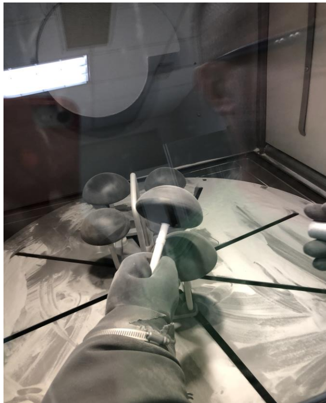
Ilustración 13 - Proceso de Baño de Arena
