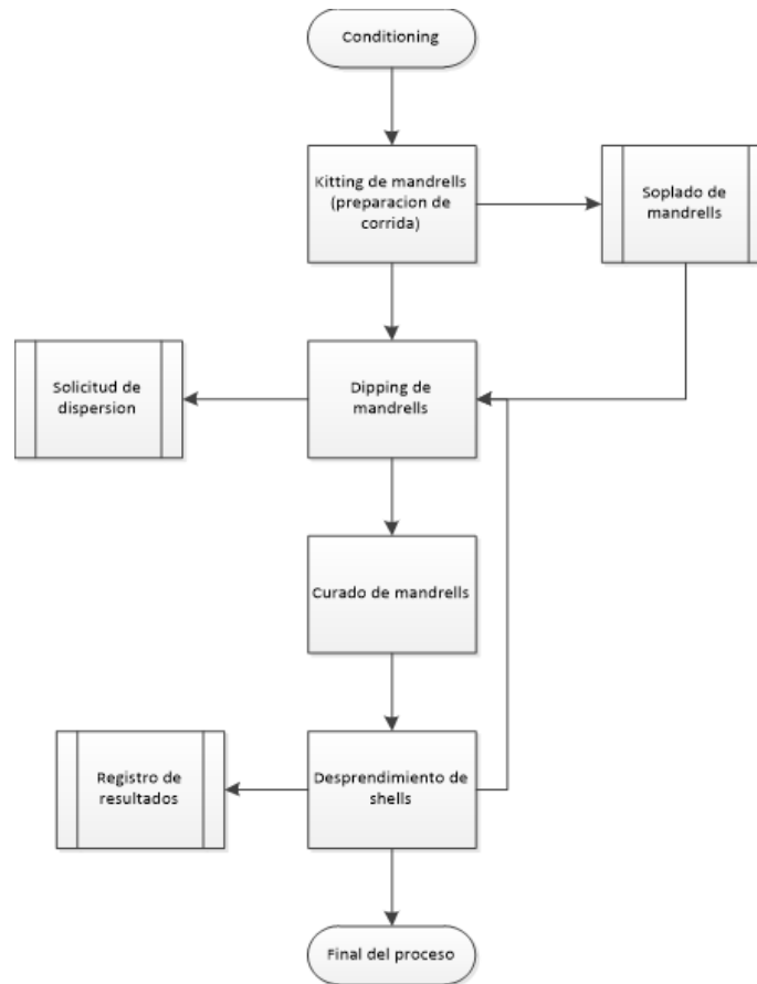
Ilustración 21 - Diagrama de flujo del proceso de Acondicionamiento
