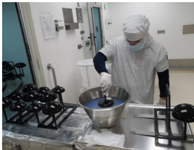
Ilustración 14 - Método actual de acondicionamiento de moldes
