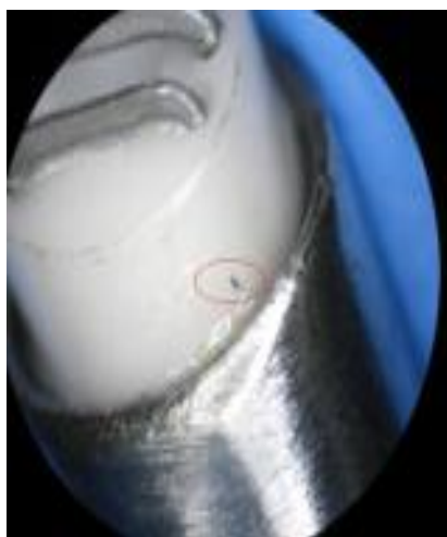
Figura 13 Partículas metálicas en el parte principal del Dispositivo
