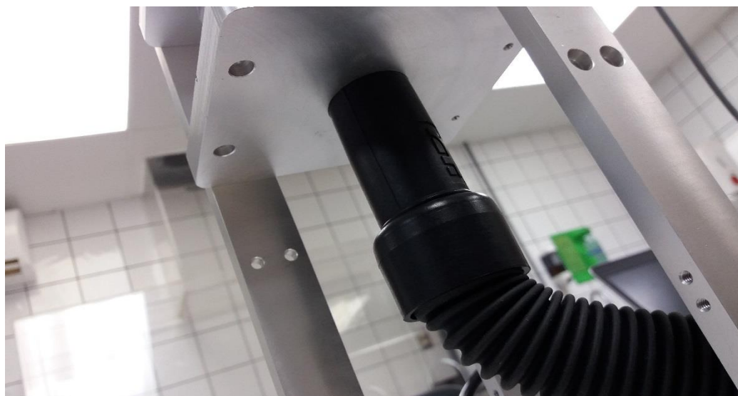
Figura 35 Acople del Omega Supreme Quiet Vacuum al prototipo final.
