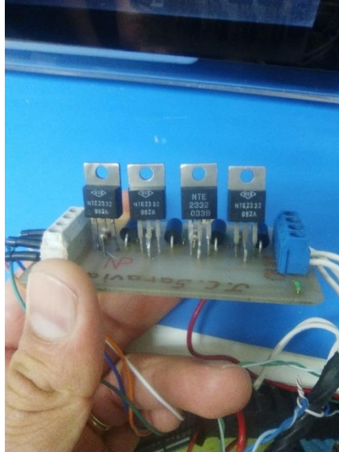
Figura 23. Amplificador de motor paso a paso
