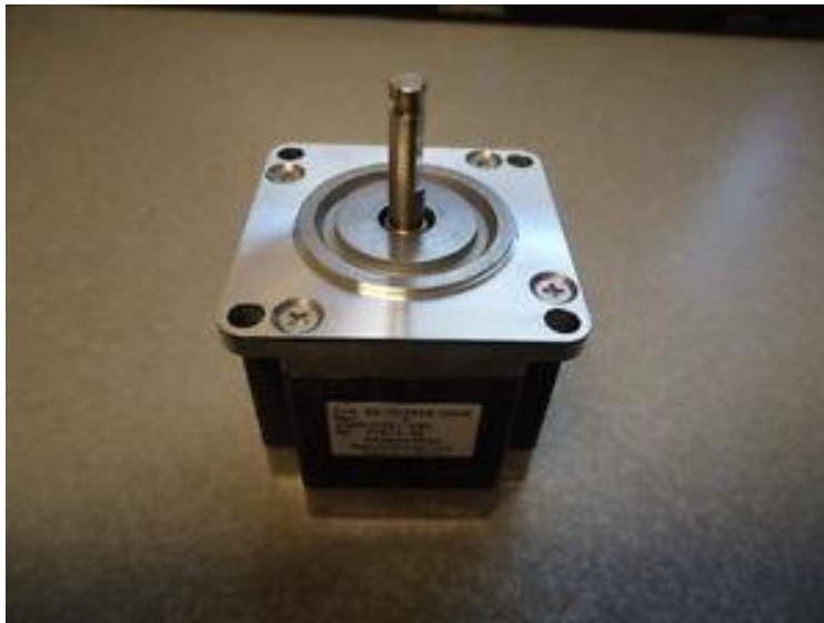
Figura 27. Motor paso a paso utilizado
