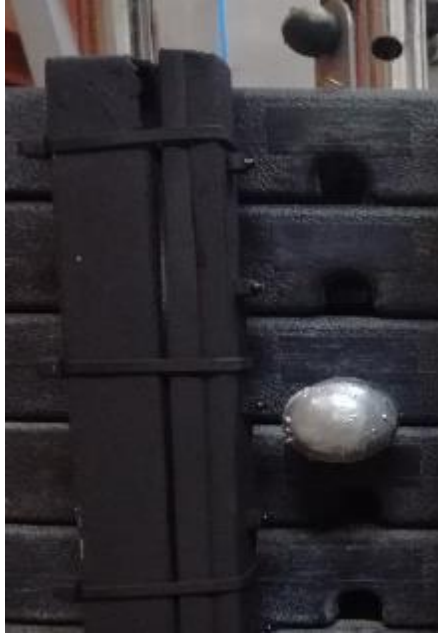
Figura 26. Detección de la posición del pin selector de peso en la máquina minigimnasio.
