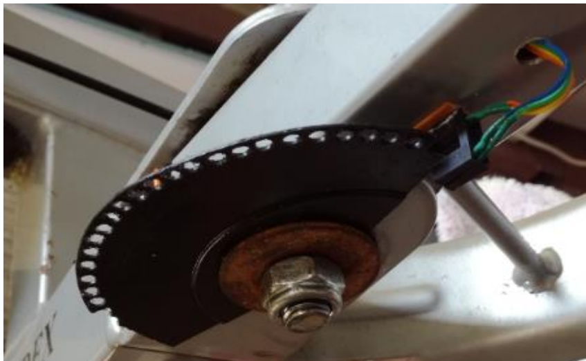
Figura 47. Disco media luna con 23 perforaciones alrededor.
