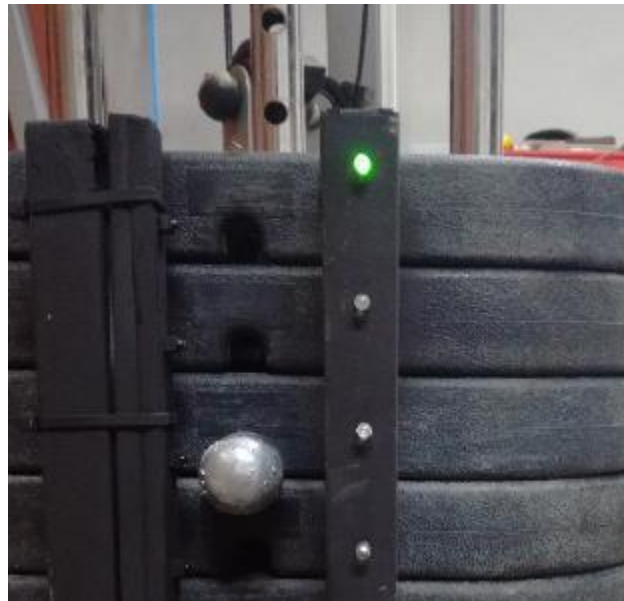
Figura 27. Leds de señalización para configurar el peso correctamente.
