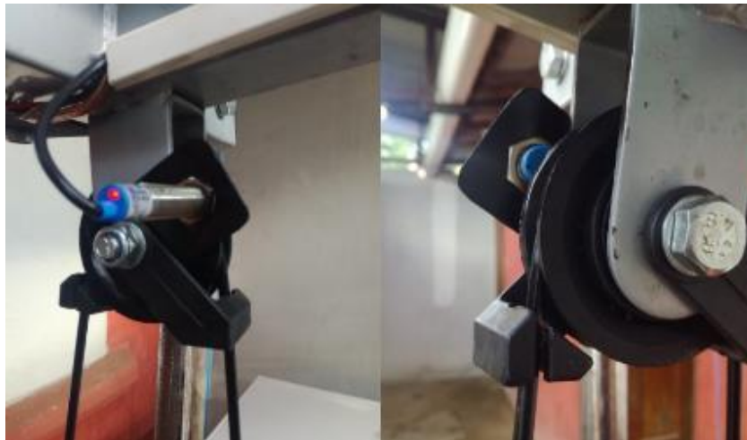
Figura 31. Sensor inductivo para la detección del giro de polea.
