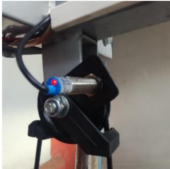
Figura 52. Sensor inductivo para medir el giro de la polea inicial de la máquina de gimnasio.
