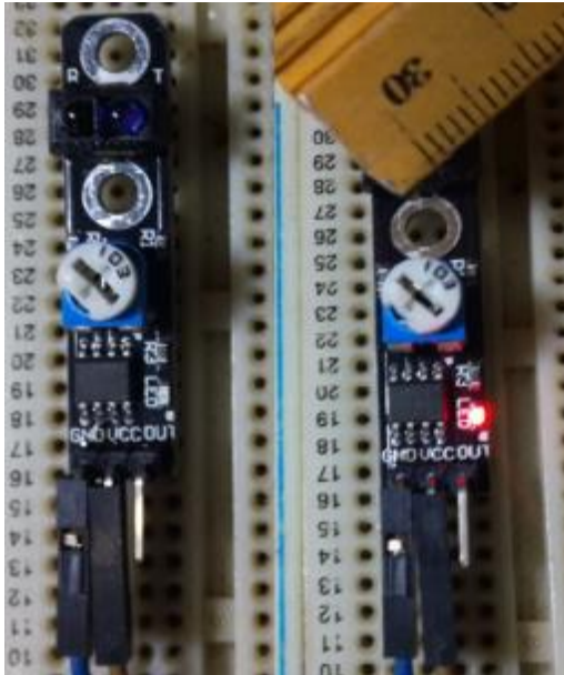
Figura 41. Sensor TCRT detectando objetos.
