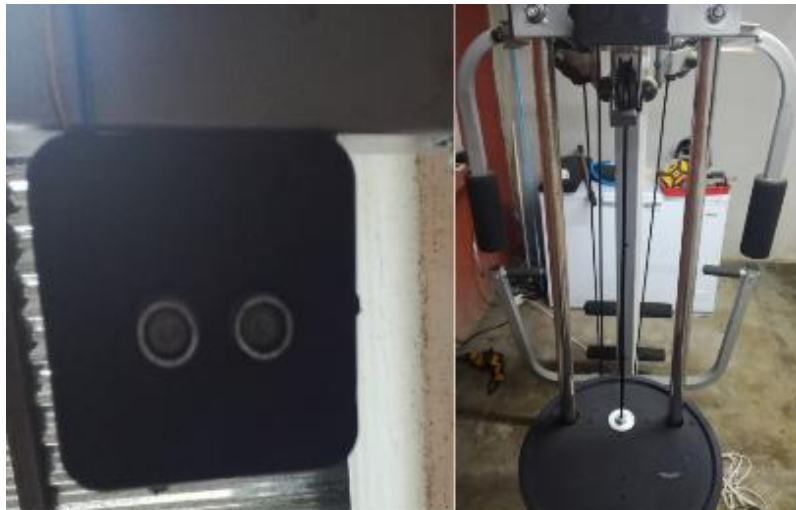
Figura 25. Descripción de la instalación del sensor ultrasónico en la máquina y su reflector sonoro.
