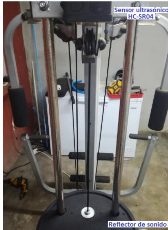
Figura 38. Instalación de sensor ultrasónico y reflector de sonido.
