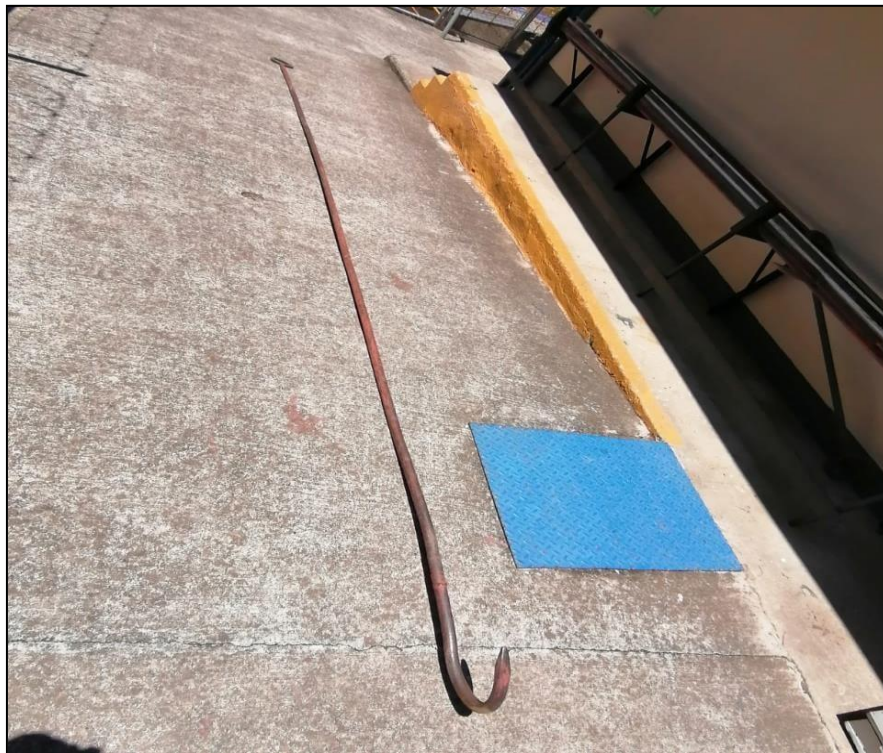
Imagen 12. Gancho para realizar limpieza de parrilla de la presa.
