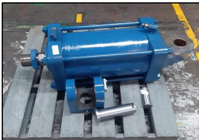
Ilustración 43: Reparación de pistón hidráulico
