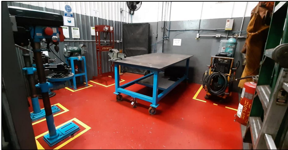
Ilustración 35: Demarcación de áreas en cuarto de soldadura.
