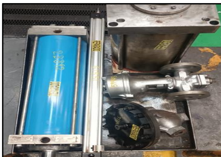
Ilustración 44: Válvulas y pistones reparados
