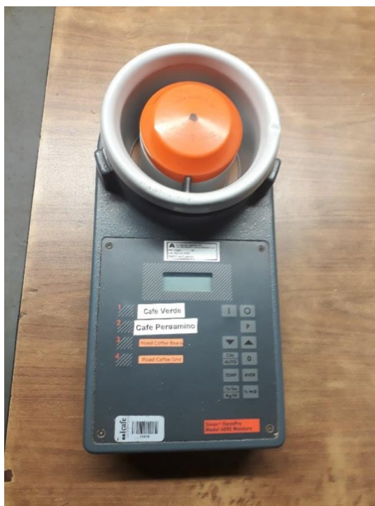
Medidor de humedad
