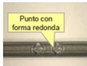
Imagen #22. Forma del punto, como debe verlo el colaborador durante su configuración básica. Documento de proceso de la estación de sellado.
