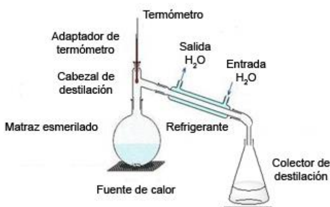
Figura 10: Diseño del equipo de destilación simple con todos sus componentes.
