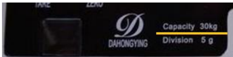
Figura 1.1: Imagen donde se señala la ubicación de la indicación de la capacidad máxima de la balanza, además de la indicación del valor mínimo que mide la misma, esto indica de cuanto en cuanto varía la medición.
