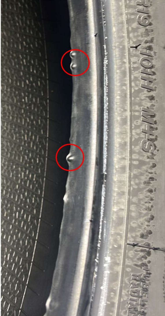
Figura 60 Defecto ampolla en ceja
