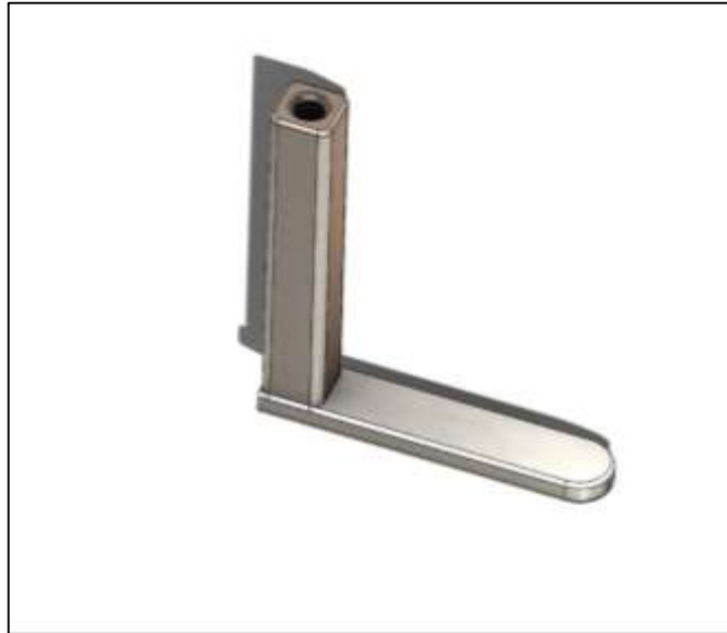
Figura 50. Diseño de herramienta de eliminación cavidades de aire.
