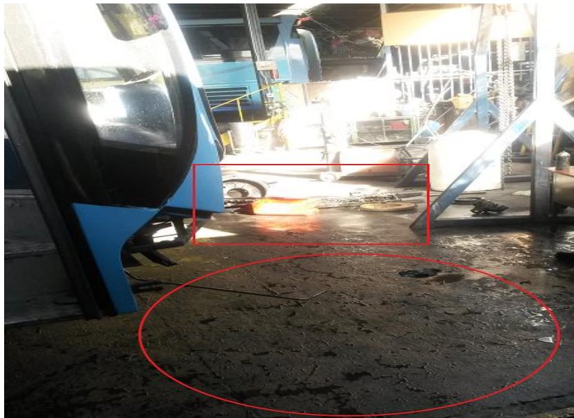
Figura 26 Derrames en los pasillos
