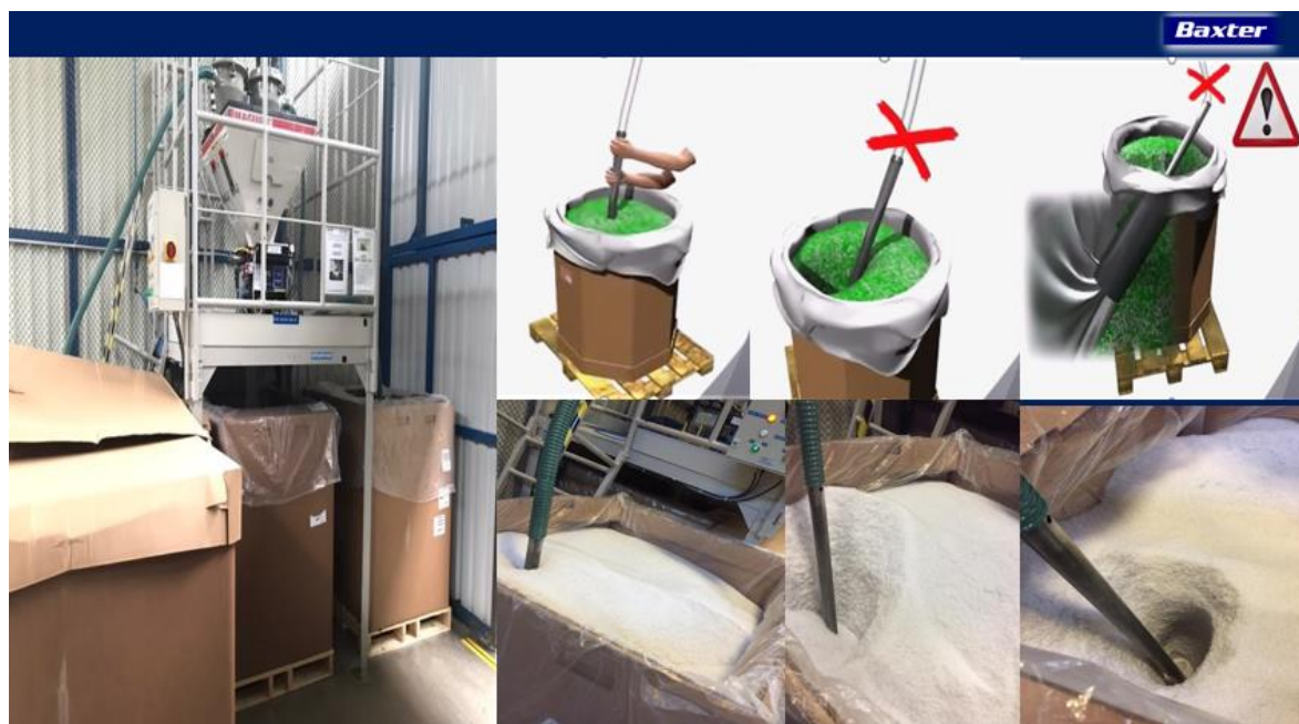
Figura 39, Problema succionado en la Mezcladora.
