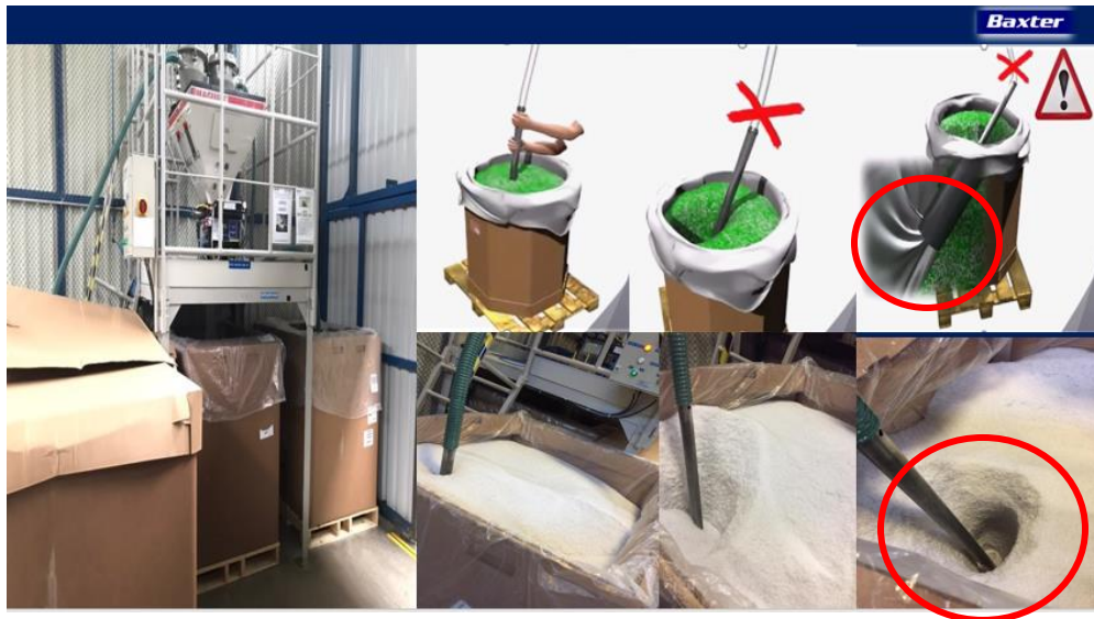
Figura 41. Problema de succionado al vacío
