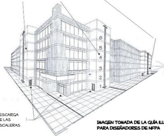
DUCTOS DE ESCALERAS DE EMERGENCIA PROTEGIDOS, CON LA RESISTENCIA AL FUEGO REQUERIDA SEGÚN LA CANTIDAD DE PISOS DEL EDIFICIO Y TIPO DE OCUPACIÓN
