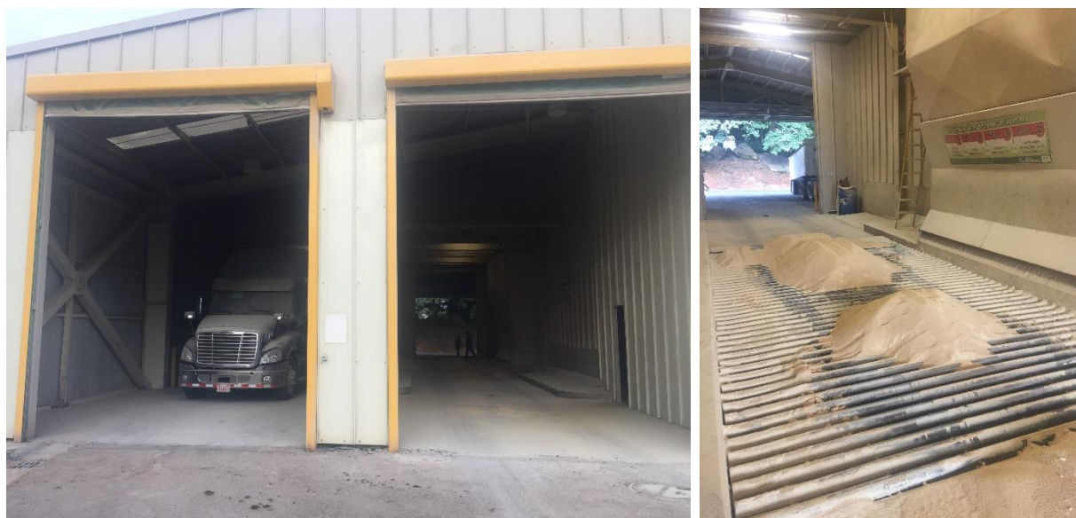
Figura 11 Área de recibo de materias primas. A la derecha lo que se conoce como piquera de descarga. Fuente: Elaboración propia.
