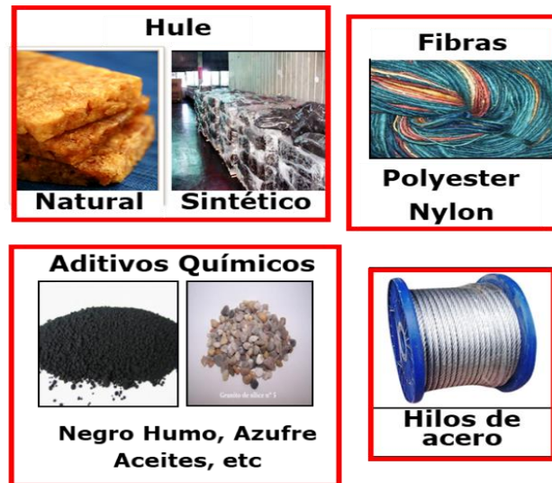
Imagen 13 Materias primas para la elaboración de llantas
