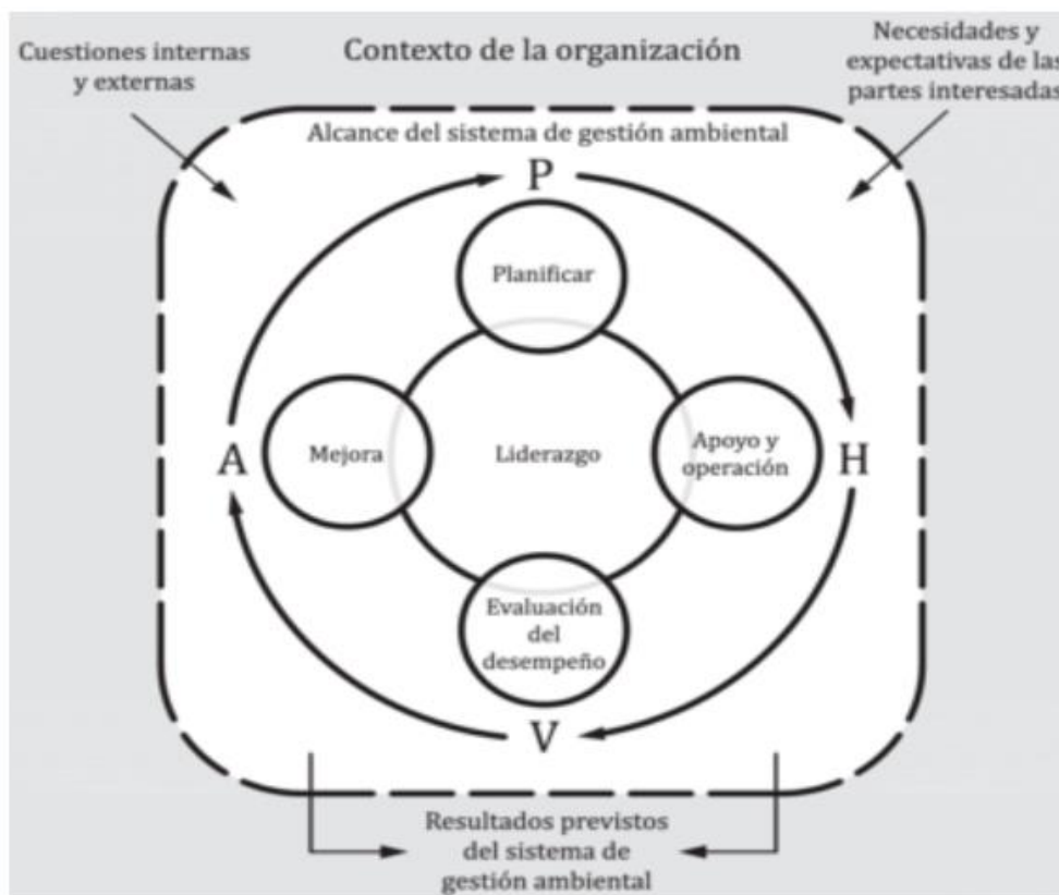
Figura n.º 4: Relación entre el modelo PHVA y el marco de referencia Norma ISO 14001
