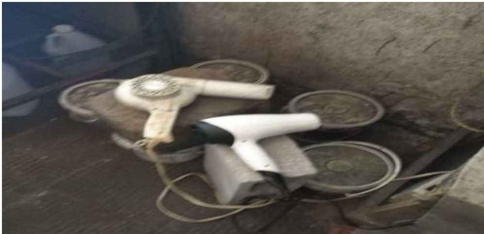
Figura 26 Técnica de secado para marcos en la etapa de Serigrafía.
