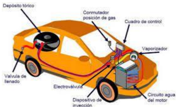
Ilustración 14 - Componentes Sistema Gas LP
