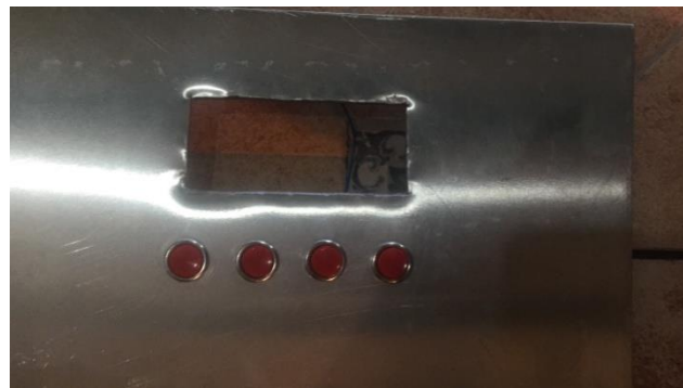
Figura 45 Instalación de botones y LCD
