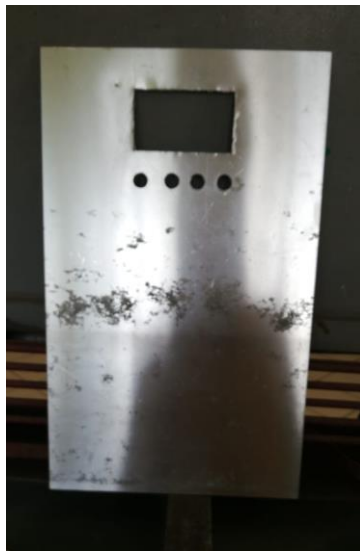
Figura 44 Orificios para LCD y botones
