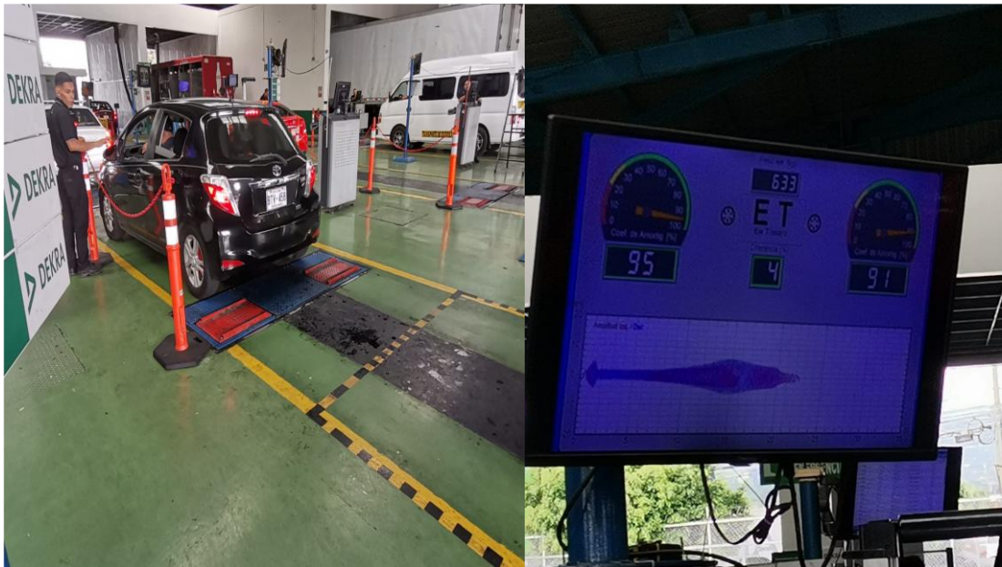
Figura 12. Prueba mecanizada de banco de suspensión.
