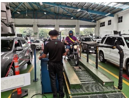
Figura 15. Rampa de motos (frenómetro y banco de gases).
