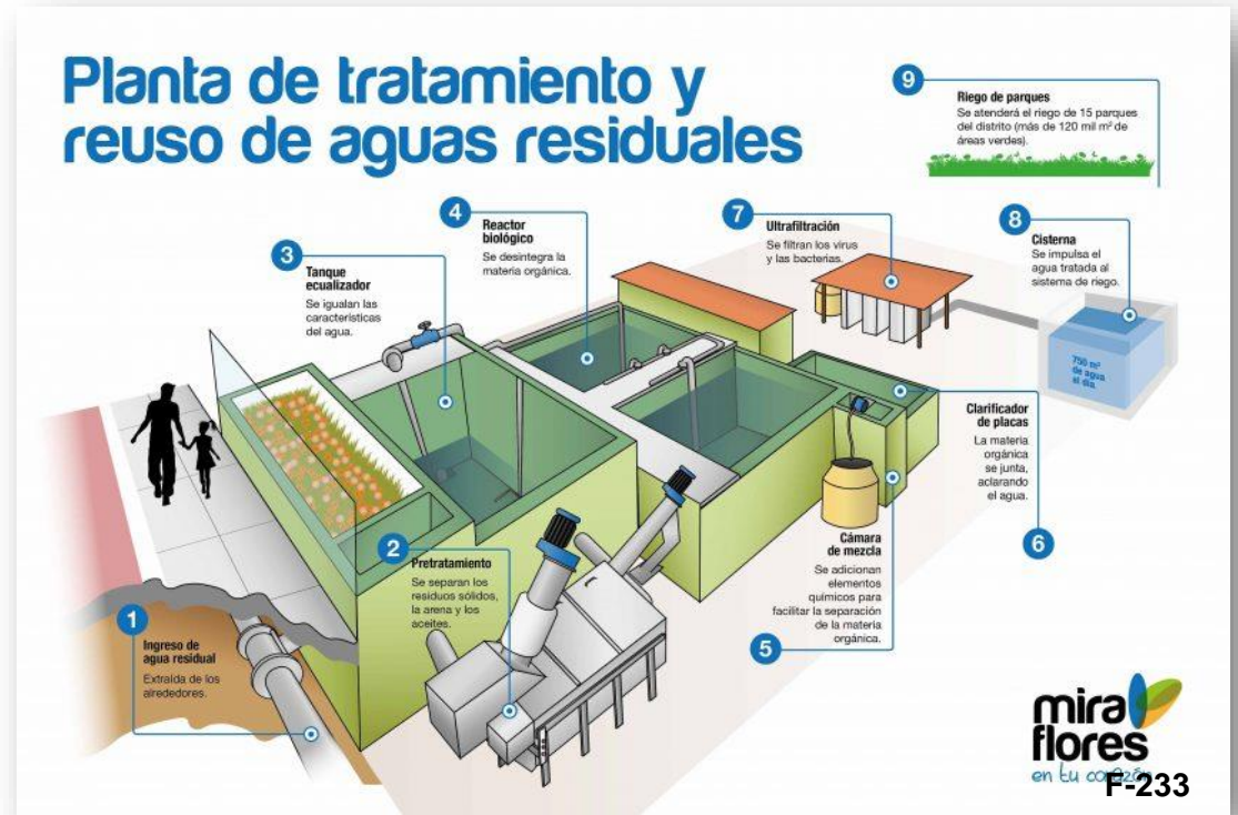
Diagrama de planta de tratamiento
