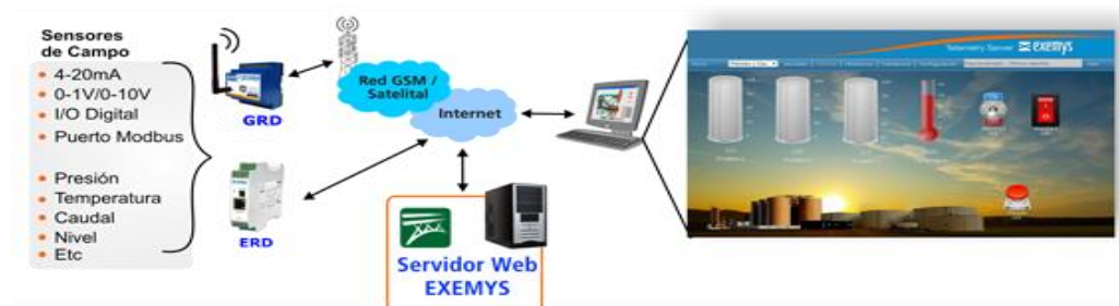
Figura 19. Diagrama de funcionamiento de los dispositivos GRD y ERD.
