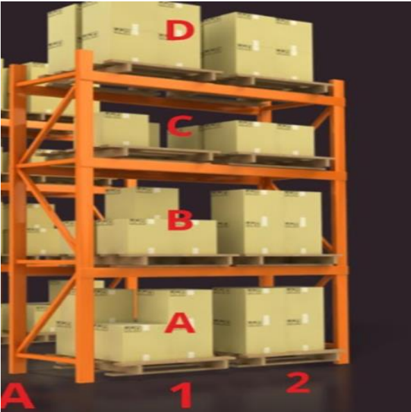
Figura 22 Ejemplo de identificación de rack
