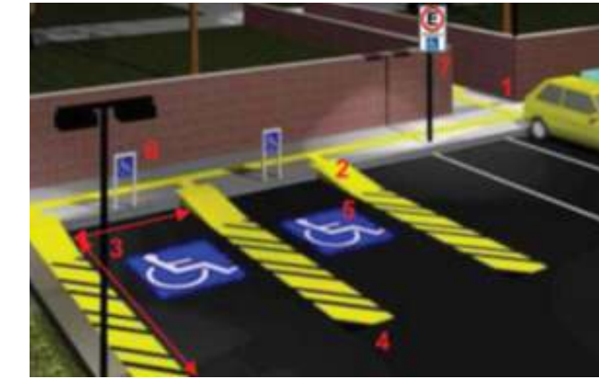
Figura 105. Configuración básica de estacionamiento accesible.
