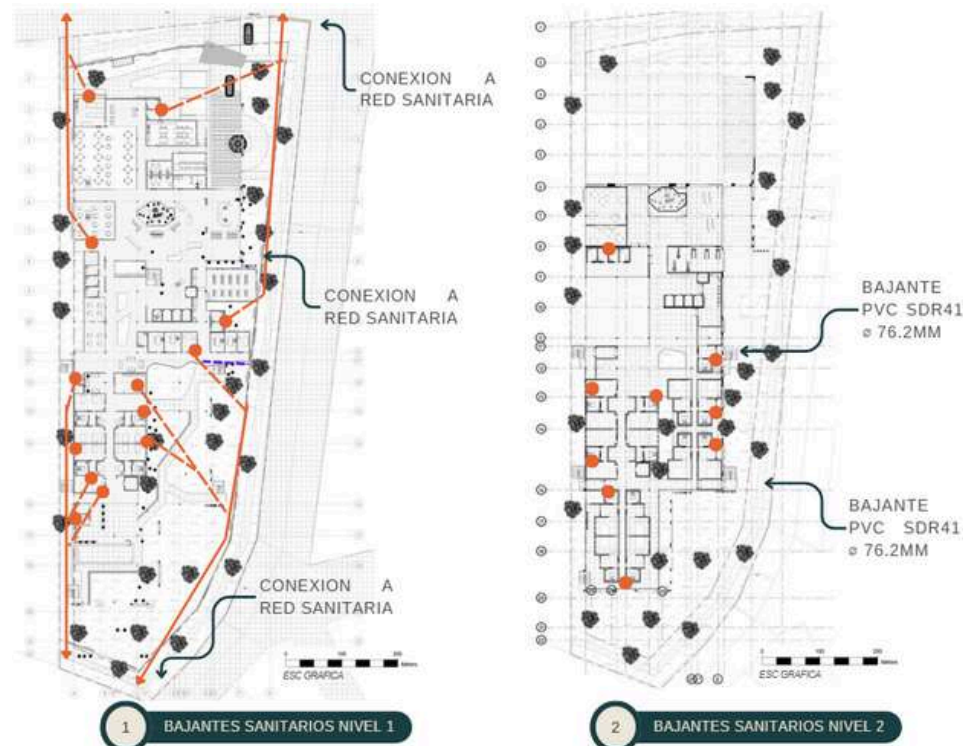
Figura 174. Planta Arquitectónica Evacuación Sanitaria.
