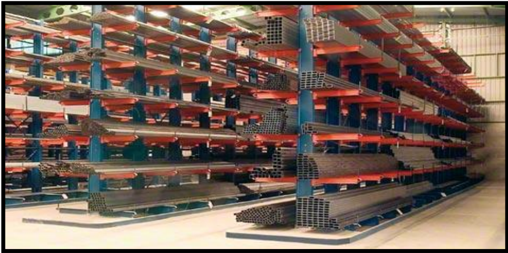
Figura 22 Ilustración Estantería Cantiléver
