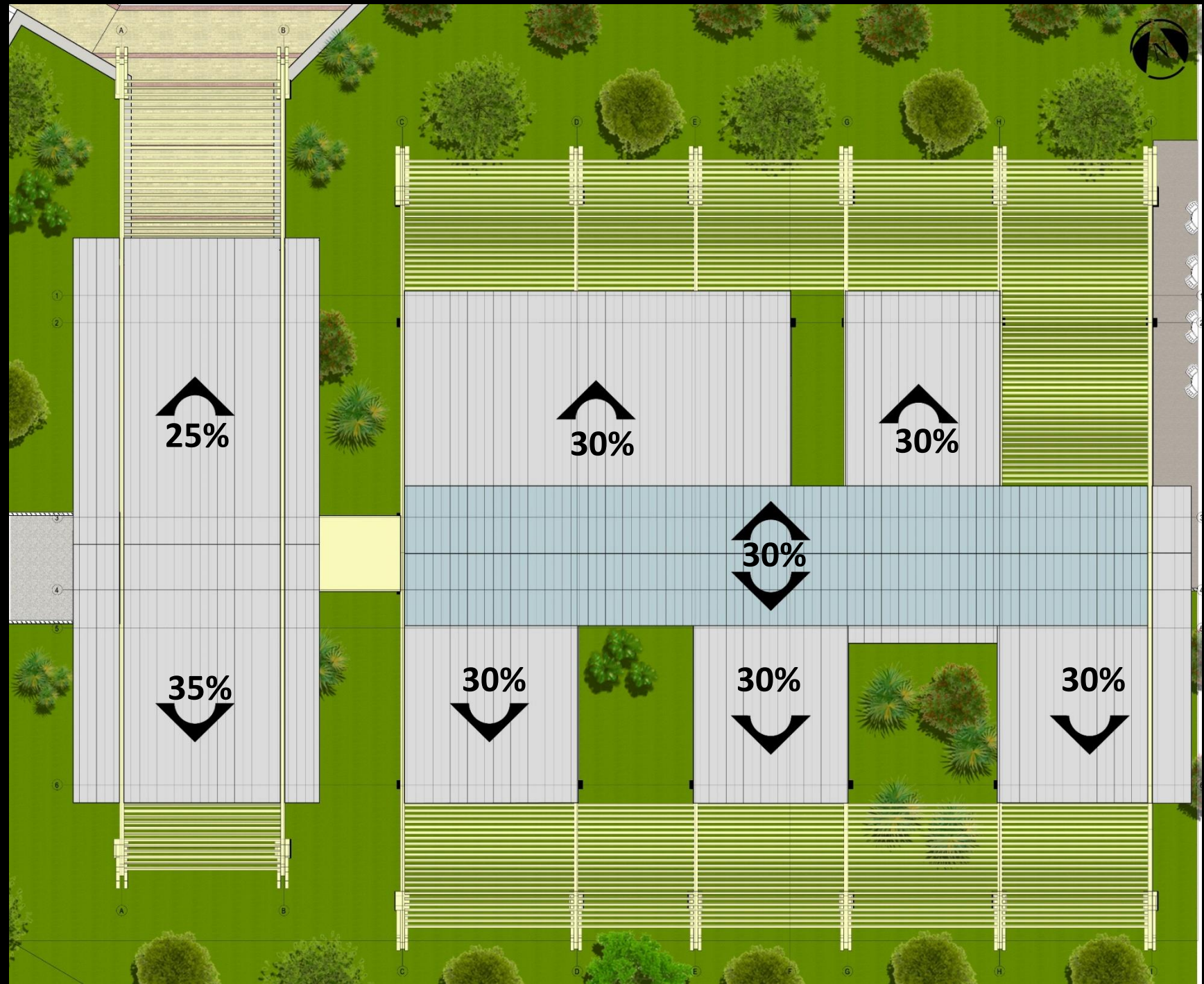
Planta techos edificio principal-
