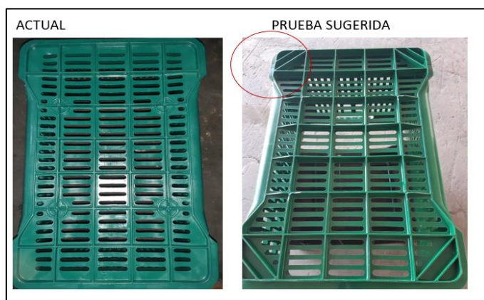
Figura 26. Imagen sugerencia de prueba reforzamiento en fondo de cesta
