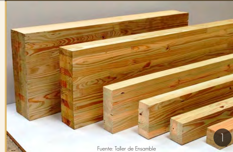
DIFERENTES SECCIONES EN VIGAS RECTAS DE MADERA LAMINADA ENCOLADA EN MADERA DE TECA
