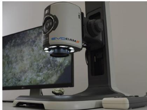
Figura 26 Microscopio utilizado en la estación de Shrinking Bellows para la inspección del Bellow
