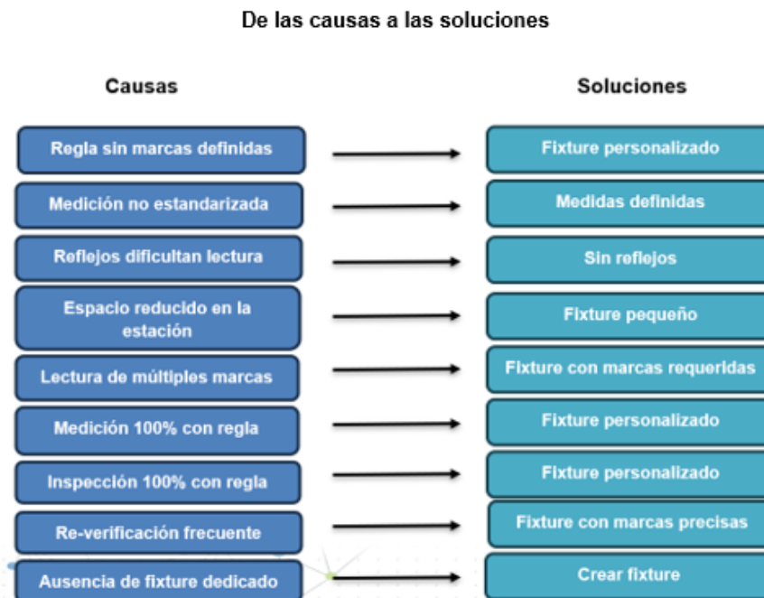
Figura 29 Análisis de posibles causas y sus respectivas soluciones.
