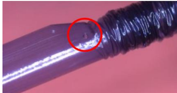
Figura 25 Defecto bajo microscopio rasgaduras en el Bellow
