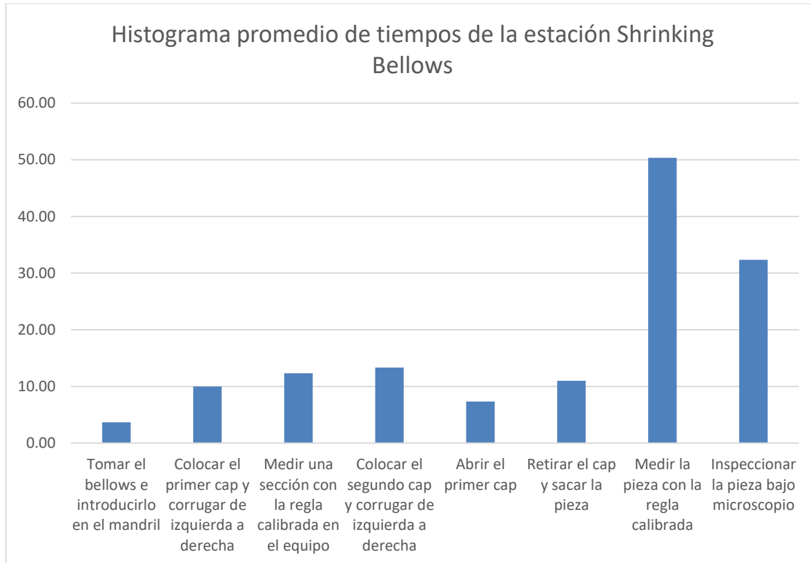
Figura 24 Histograma promedio de tiempos de la estación Shrinking Bellows
