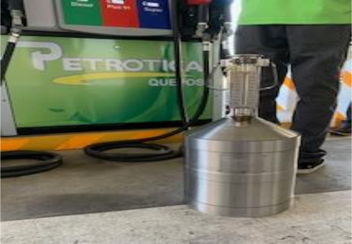
Apéndice 7. Dispositivo para la medición de los dispensadores para ver si hay una alteración.
