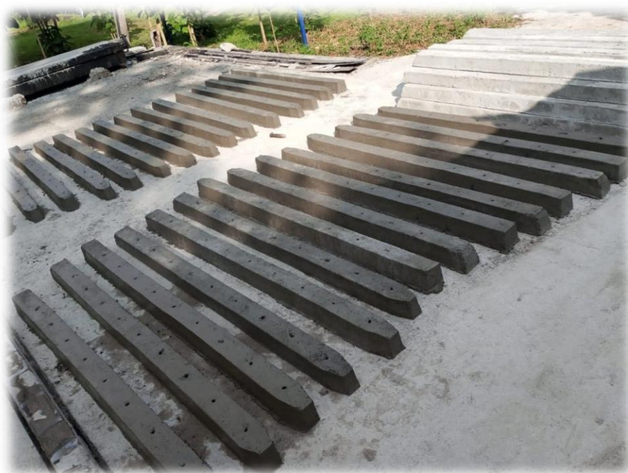
Figura 4. Postes de concreto en etapa de secado y almacenamiento
