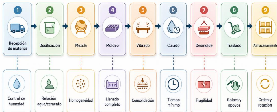
Figura 9. Flujo actual con puntos críticos de control
