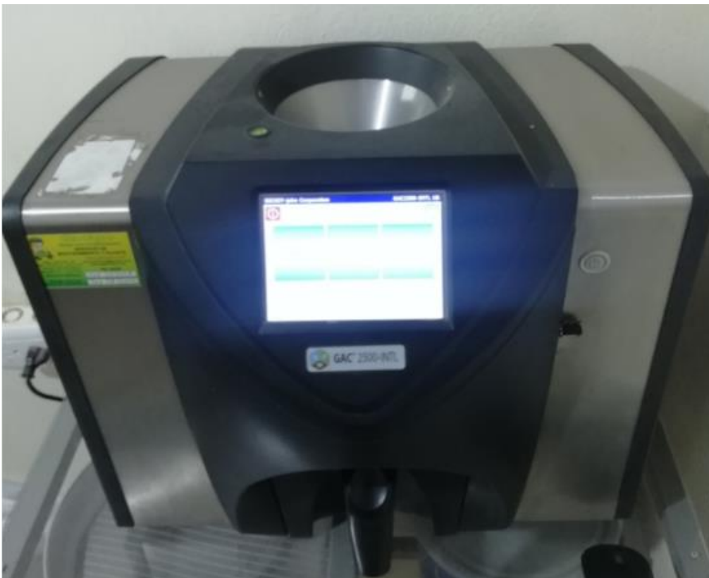
Figura 20 Motón: medidor de humedad
