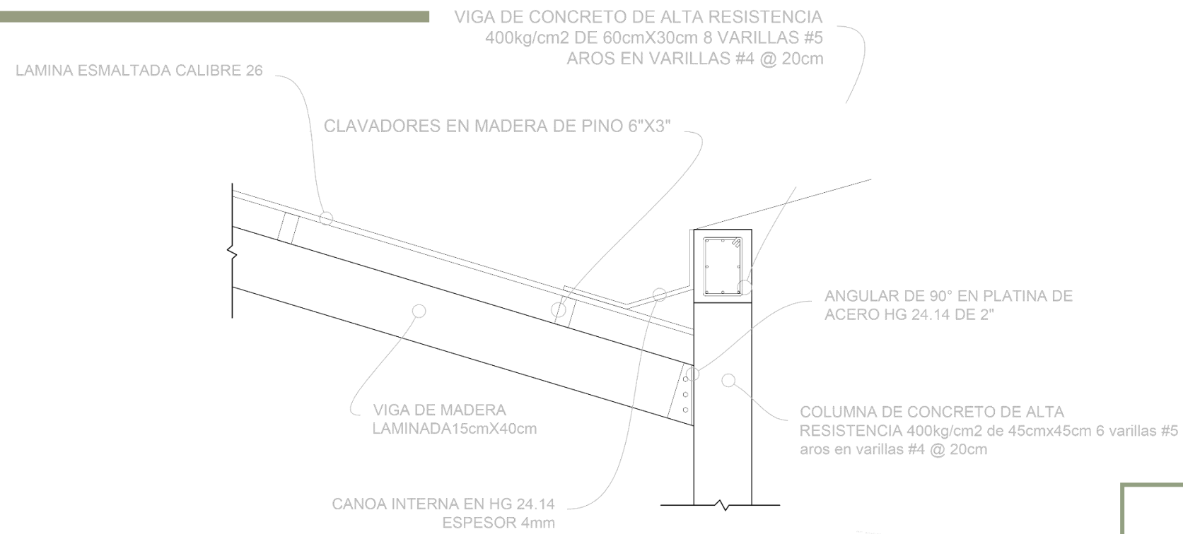
DETALLE CLAVADORES Y CANOA INTERNA ESCALA 1:25
